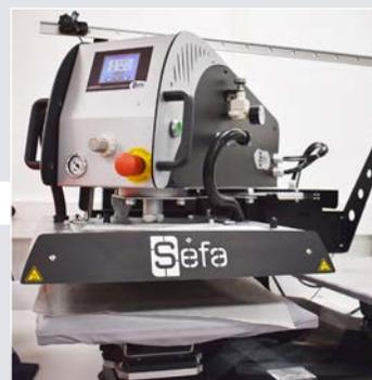
Presse à chaud, double plateaux avec membrane
